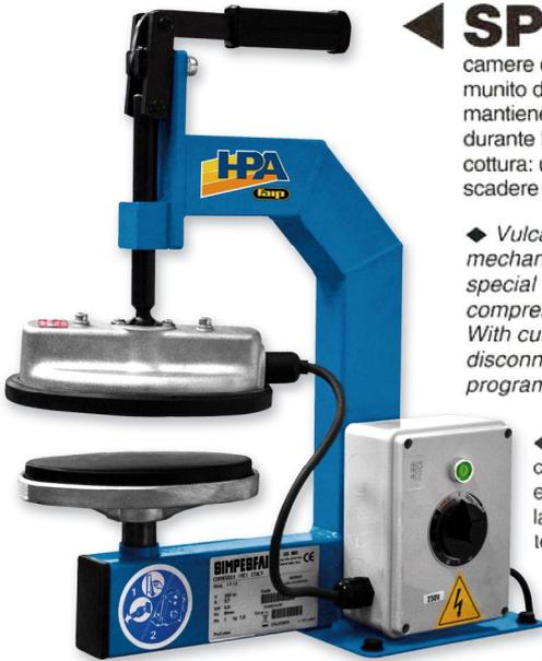
◀ **SP 12** ◆ Vulcanizzatore per camere d'aria a chiusura meccanica rapida, munito di uno speciale dispositivo che mantiene costante la forza di compressione durante la cottura. Con regolazione di cottura: un timer interrompe il circuito allo scadere del tempo programmato.
