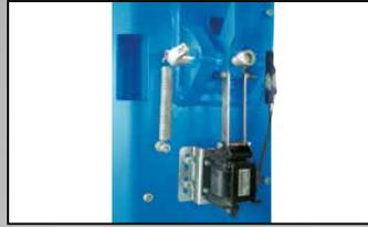
Entriegelung der Sicherungen mit **Elektromagnet 24V.**
