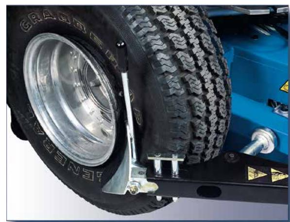
**Le bras détalonneur** permet une ouverture jusqu'à 370 mm, et il est équipé d'un régulateur de course pour éliminer la possibilité d'écrasement du pneu. Le détalonneur est actionné par un vérin pneumatique à double effet entièrement réalisé en acier inox qui développe une puissance de 15500 N sur la palette.
