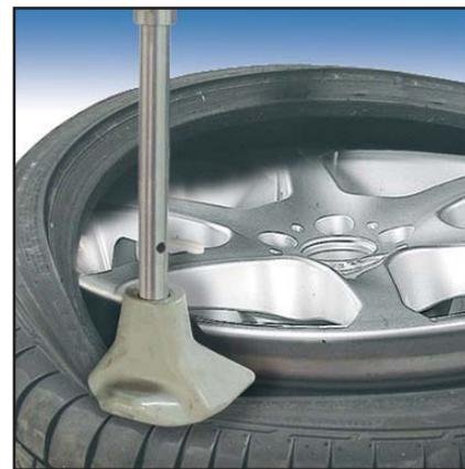
Il **pressore** mantiene il tallone del pneumatico nel canale del cerchio: in fase di smontaggio, posizionato dalla parte opposta alla torretta e abbassato sul pneumatico fino a portare il tallone in corrispondenza del canale del cerchio, consente al tallone stesso di non essere in eccessiva tensione e di salire più agevolmente sulla torretta.
