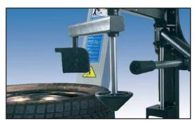
Beweglicher Wulstniederhalter. Drehbarer niederhalter, der den reifenwuls im Felgenbett hält.
