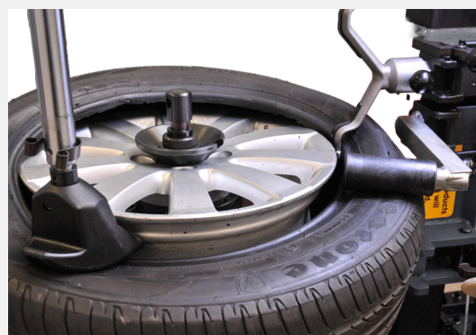
Braccio premi-tallone pneumatico + rullo pressore di serie
