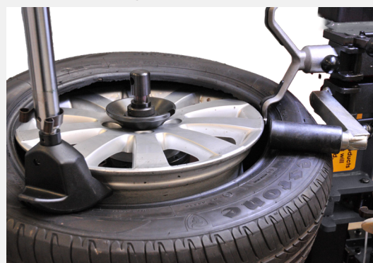
Bras presse-talon pneumatique + rouleau presseur de série
