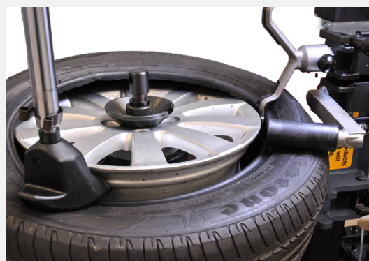
Brazo destalonador neumático + rodillo presor de serie
