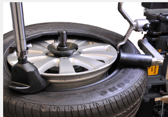
Pneumatischer Andruckarm + serienmäßige Andruckrolle
