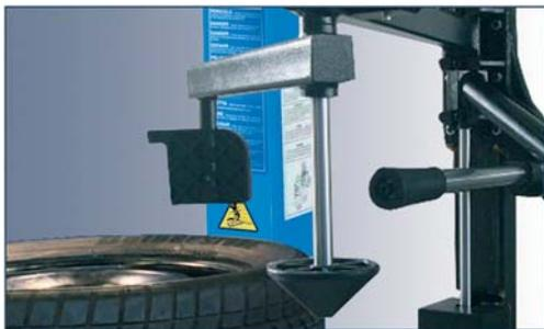
**Il pressore rotante** mantiene il tallone del pneumatico nel canale del cerchio. Il **cono premicerchio** favorisce il bloccaggio del cerchio sull'autocentrante in presenza di pneumatici rigidi.
