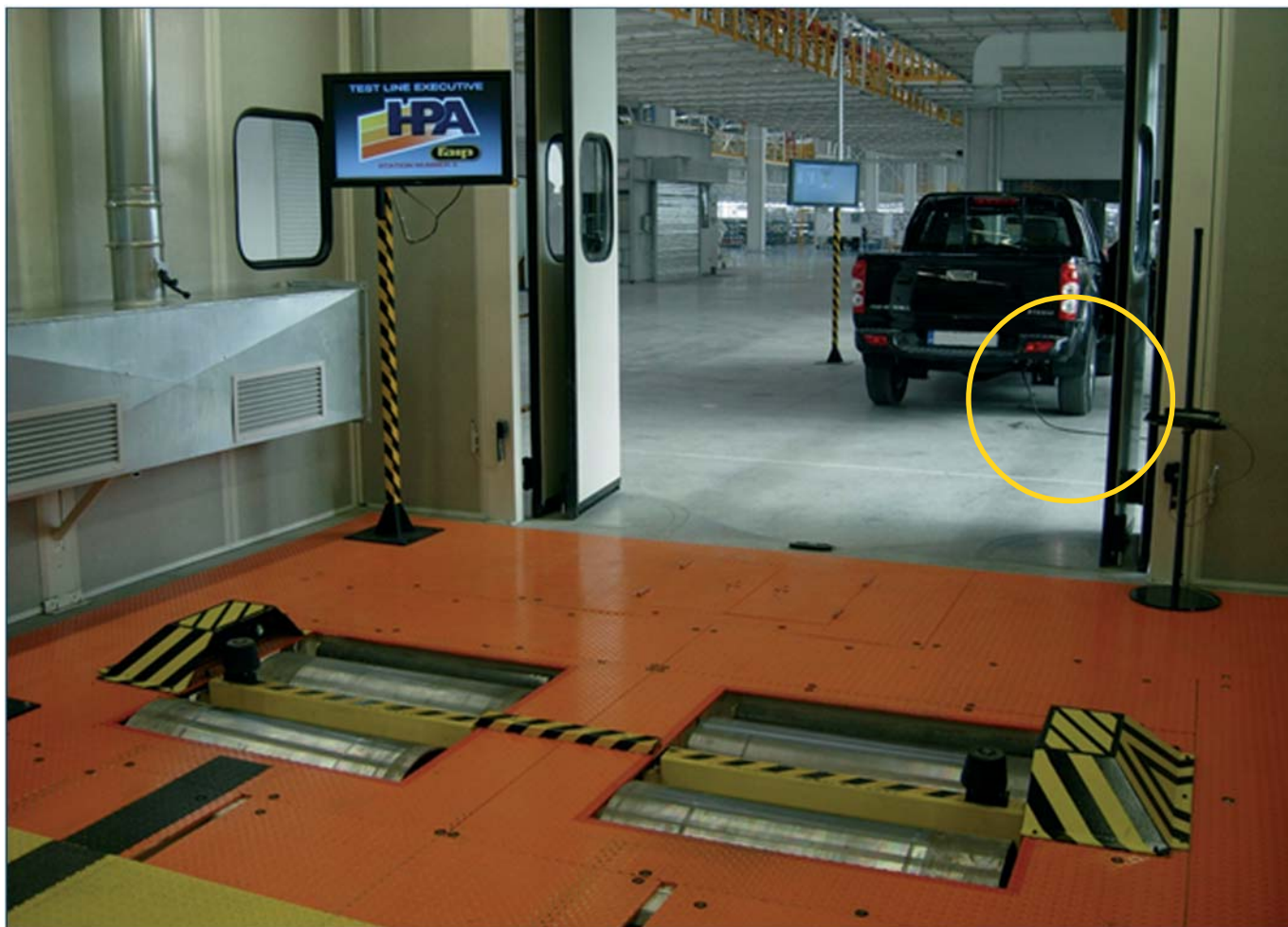
Prelievo gas di scarico da analizzare all'uscita cabina banchi rulli (Veicolo caldo). Exhaust gas sampling to be analyzed at the exit of roller benches cabin (Hot vehicle).
