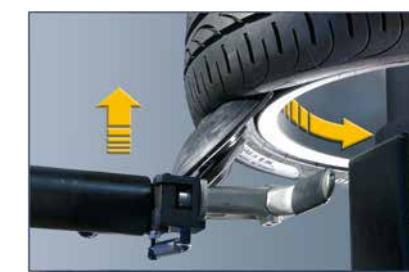
El disco destalonador del revolver presiona hidráulicamente el neumático y el movimiento de la rueda que se produce al mismo tiempo, facilita la destalonadura superior.
