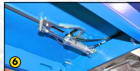
6. Pedane oscillanti con bloccaggio pneumatico da centralina. Sliding plates with air central locking.
