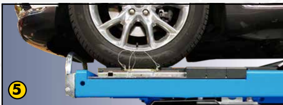
5. Incavo per piatto rotante registrabile. Adjustable recess for the turntable.
