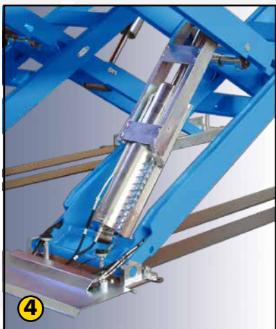
4. Cremagliere di stazionamento registrabili. Adjustable mechanical safety device.
